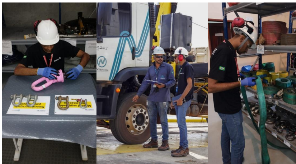
Inspeção de equipamentos e acessórios de movimentação de carga
